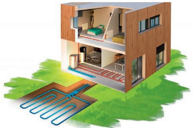
La géothermie (ou « chaleur de la terre ») consiste à capter les calories contenues dans le sol pour chauffer la maison et éventuellement produire de l'eau chaude sanitaire au moyen d'une Pompe à chaleur.
