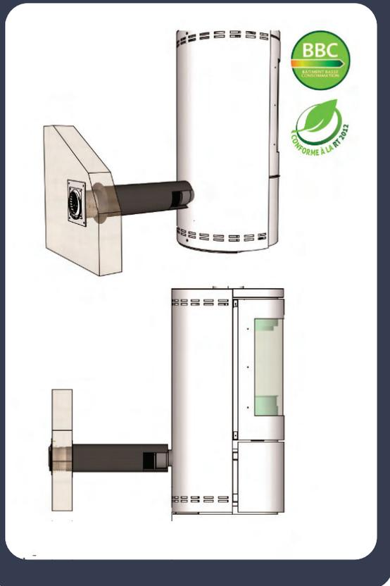
**Arrivée d'air indirecte :** c'est-à-dire sans branchement possible sur l'appareil.
