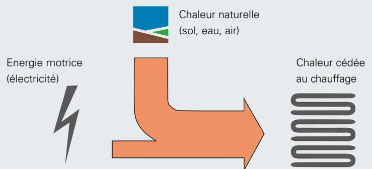
$$\text{Coefficient de performance (COP)} = \frac{\text{chaleur cédée}}{\text{puissance électrique}} = \frac{4 \text{ kW}}{1 \text{ kW}} = 4$$
