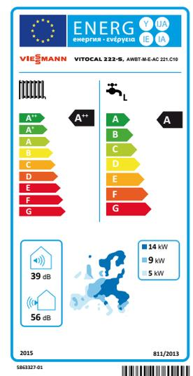
L'étiquette produit de la Vitocal 222-S fait apparaître l'efficacité énergétique en chauffage et eau chaude sanitaire, mais également les émissions sonores des unités intérieure et extérieure
