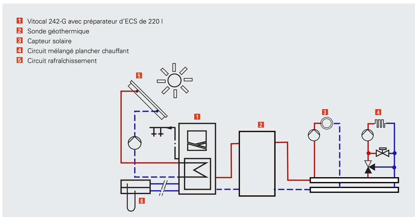
Représentations schématiques fonctionnelles, l'installation devra se faire avec un schéma détaillé.
