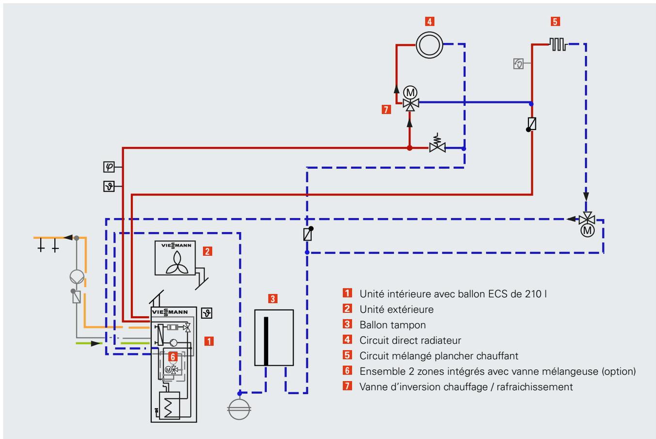
Représentations schématiques fonctionnelles, l'installation devra se faire avec un schéma détaillé.
